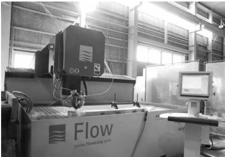
平成 21 年 12 月には世界最高吐出圧力 87000PSI/600MPa のポンプを備えた最新のウォータージェット切断加工機を導入しました。これにより、最大切断厚さを 200mm まで可能とし、より速くかつ高品質のウォータージェット加工を提供してまいります。
