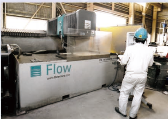
■ウォータージェット切断機2号機(Flow製) レーザー・プラズマでは不可能だったステンレス材、板厚200mmまでの厚板の精密切断を可能にしました。
