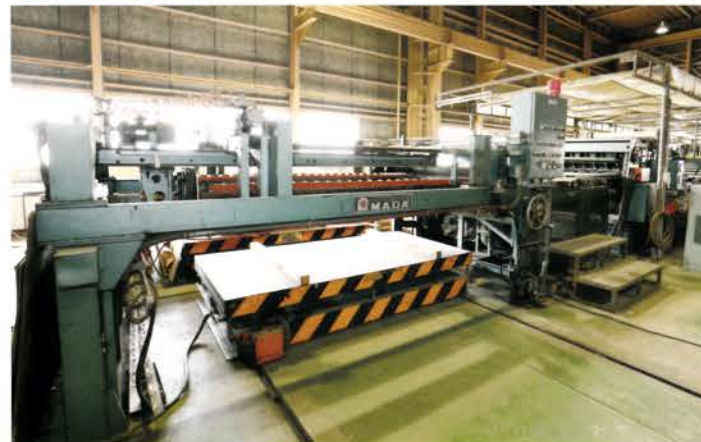
■レベラーシャーリング切断機 No5(西神工場)
