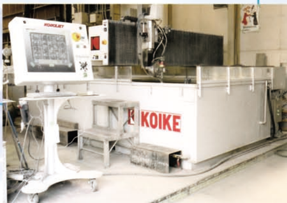
■ウォータージェット切断機3号機 (小池酸素工業製)
